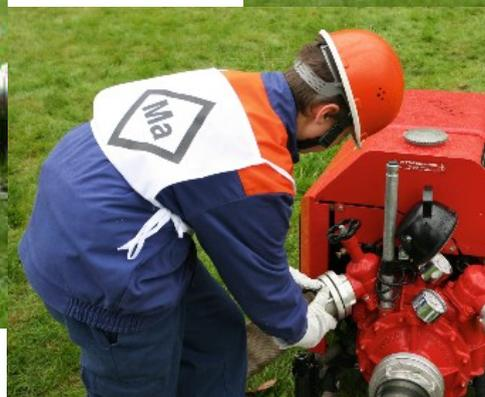
Nachdem die Wasserversorgung zum Unterflurhydranten hergestellt ist, verlegt der Wassertrupp den B-Druckschlauch ohne Schlauchverdrehung durch den Wassergraben bis zum Verteiler.
