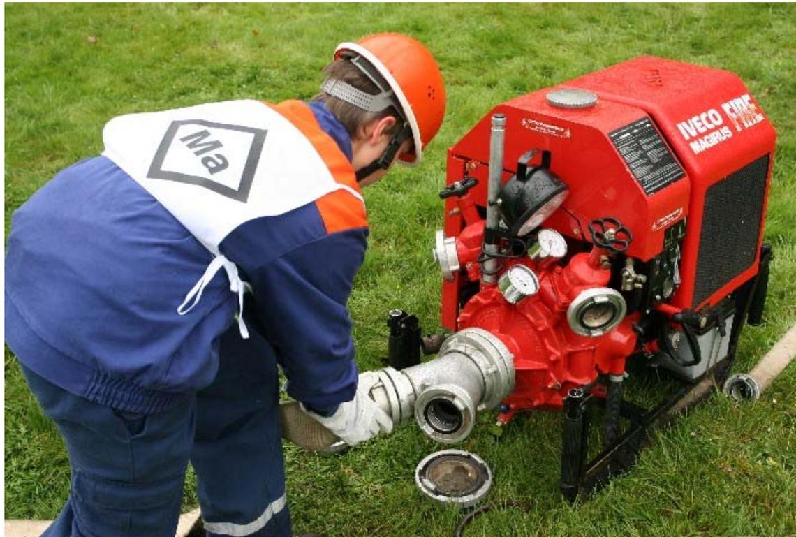
Der Maschinist kuppelt den B-Druckschlauch an die TS an.
