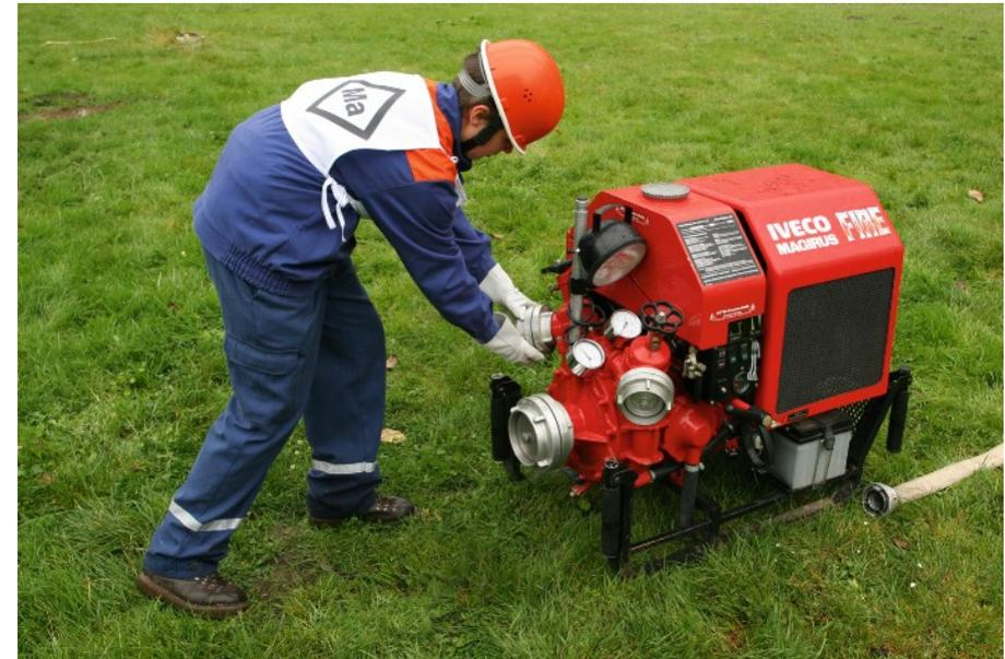
Der Maschinist holt vom Ablageplatz die für die Wasserentnahme notwendigen Geräte (Sammelstück und Kupplungsschlüssel ).
