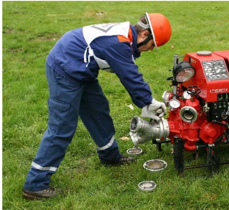
Der Maschinist kuppelt das Sammelstück mit Hilfe des Kupplungsschlüssels an die TS an.
