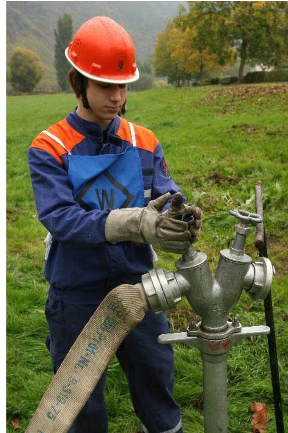
Der B-Druckschlauch ist von der TS zum Standrohr zu verlegen und am Standrohr anzukuppeln.
